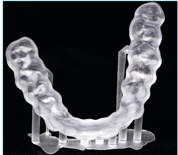
Abb. 3 Gereinigte Schiene auf Trägerplatte
