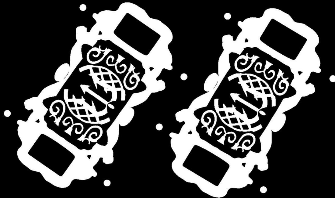
Hier ist schön zu sehen, wie der Composer das Objekt in viele „Buchseiten“ aufteilt. Ein sogenannter „Slice“ Der Projektor im Pico 2 wirft nacheinander das Objekt aufgeteilt in die Slices auf die Unterseite des Buildtrays und härtet das darin enthaltene Material an dieser Stelle aus! So entsteht dann nach und nach das Objekt. Wie viele „Slices“ angelegt werden ist abhängig von der gewählten Druckauflösung und ist natürlich auch abhängig von der Bauhöhe des Objektes.
