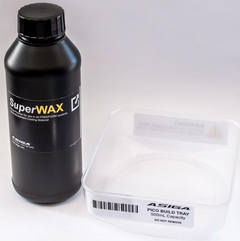
**SuperWax kommt in einer 500ml Flasche für den Pico2, zusammen mit einem BuildTray. Die flexible Teflonschicht des Trays sorgt für ein schonendes Ablösen der frisch ausgehärteten Schicht und ermöglicht damit die Reduktion von Stützstrukturen auf ein Minimum.**
