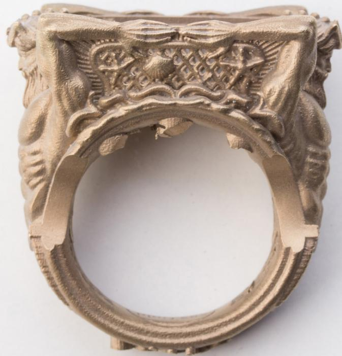
Hier sind die Gusskanäle bereits abgetrennt und das Stück sauber gestrahlt mit 100  $\mu$ . Erst jetzt lässt sich die Qualität des Gusses feststellen. Jörg hat saubere Arbeit abgeliefert. Das Gussgewicht inklusive Stützen und Mittelstamm liegt bei 75g 585 Gelbgold.
