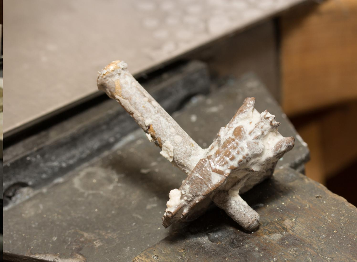
**Hier haben wir den fertigen Guss, direkt nach dem Ausbetten. Noch haftet überall etwas Gips an. Sollte nach dem Abbeizen immer noch Gips anhaften wird das Stück kurzerhand in der Sandstrahlkabine mit 100µ Glaskugeln gestrahlt.**
