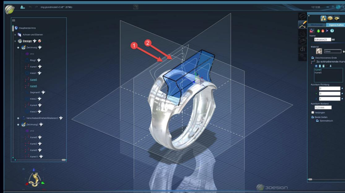
Hier zu sehen die Extrusion der Fassung aus der eben erstellten Zeichnung (1&2). Dadurch erhalten wir zunächst ein massives Objekt.
